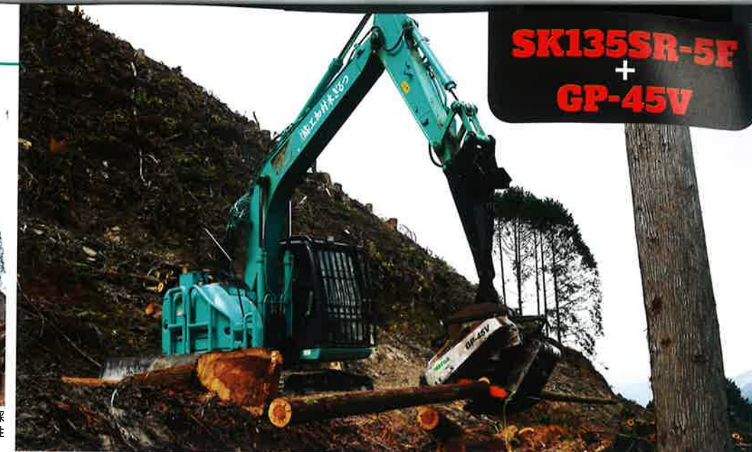
高出力エンジンと林業専用のパワー制御システムを採用。多くの油流量を必要とするプロセスのような高性能アタッチメントにも対応し、高い駆動力を発揮する。
