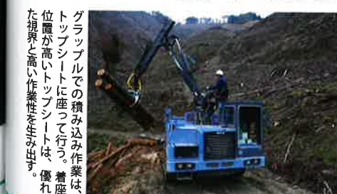
装備されているグラップルは、テレスコプ式のロングリーチ仕様。広範囲に点在している木材を、効率的に積み込むことができる。
