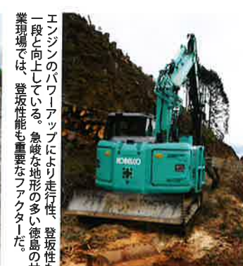
クローラ全幅2490mmを実現。狭い場所でも難なく進入し、作業することが可能。作業時の占有スペースも少なく、効率的に作業が行える。
