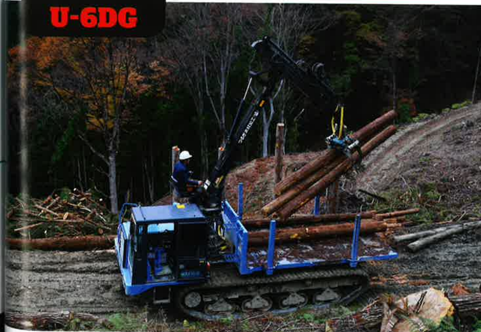
イワフジがラインナップするフォワーダのなかでも、トップクラスのサイズを持つU-6DG。最大積載量は6500kg。
