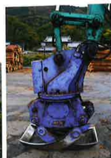
アタッチメントには、オノデラ製作所のWGB-45グラップルを装着。高トルクの旋回モーターが効率的な作業を実現。
