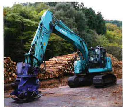
アタッチメントには、オノデラ製作所のWGB-70グラップルを装着。0.7～0.9mクラスのベースマシンに適合する。
