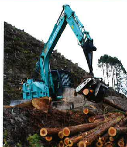
高出力エンジンと林業専用のパワー制御システムを採用。多くの油流量を必要とするプロセスのような高性能アタッチメントにも対応し、高い駆動力を発揮する。
