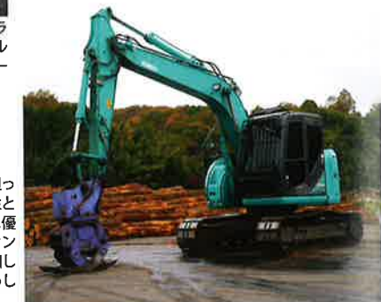
アタッチメントには、オノデラ製作所のWGB-45グラップルを装着。高トルクの旋回モーターが効率的な作業を実現。
