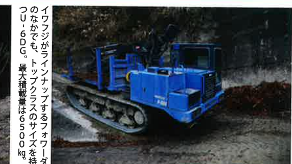
荷台前部に作業性能に優れたグラップルローダを装備。木材の積み込みから運搬まで、効率的な運材作業を実現する。
