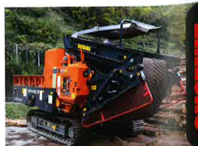
ゴムクローラを装備した日立建機製自走式木材破砕機ZR125HC。伐採現場から運ばれてきた枝や葉などを破砕し、細かなチップに加工する。
