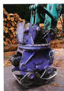
アタッチメントには、オノデラ製作所のWGB-70グラップルを装着。0.7～0.9mクラスのベースマシンに適合する。
