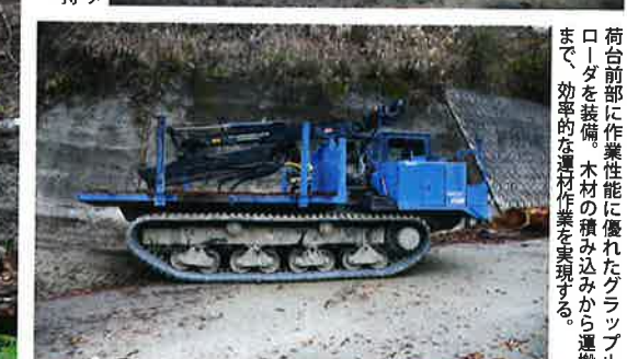
イワフジがラインナップするフォワーダのなかでも、トップクラスのサイズを持つU-6DG。最大積載量は6500kg。
