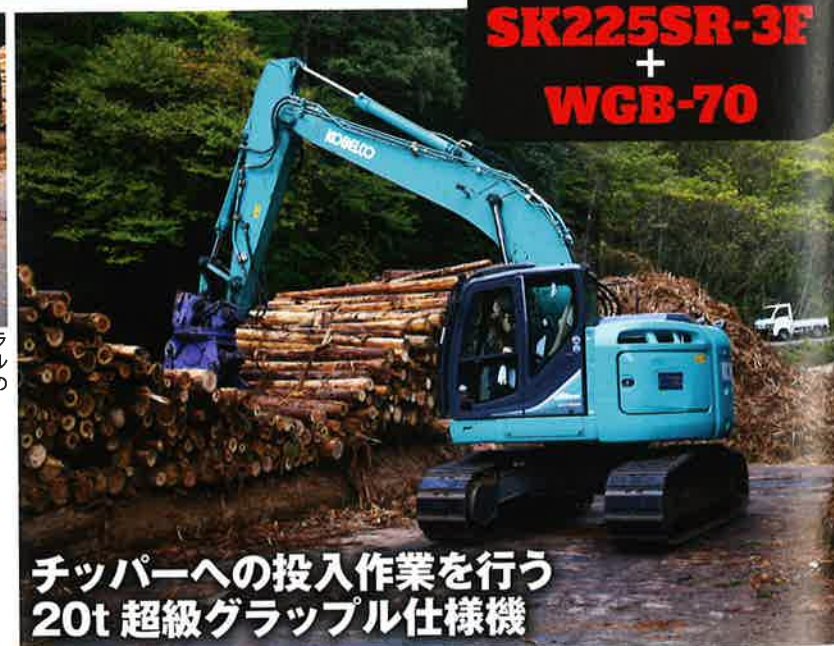
アタッチメントには、オノデラ製作所のWGB-70グラップルを装着。0.7～0.9mクラスのベースマシンに適合する。
