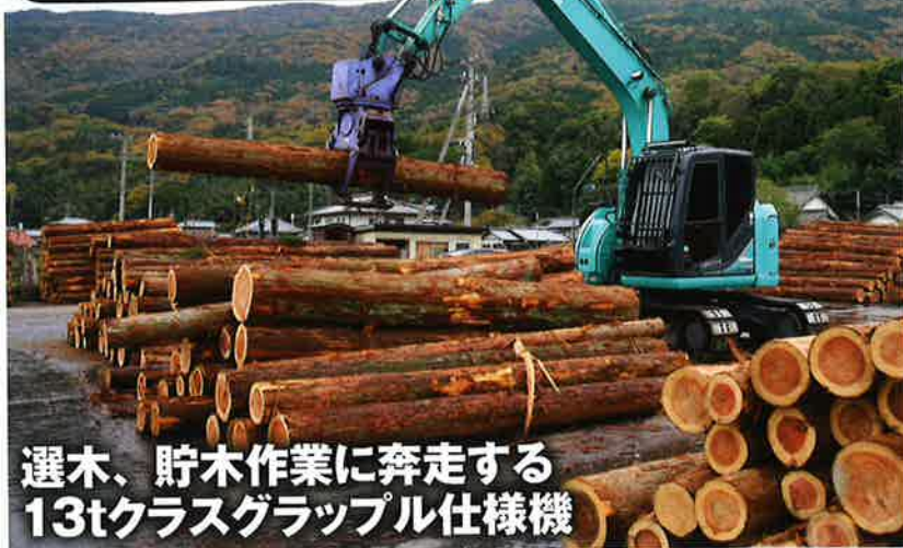
アタッチメントには、オノデラ製作所のWGB-45グラップルを装着。高トルクの旋回モーターが効率的な作業を実現。
