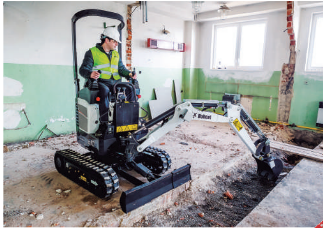
電動ミニバックホー (株)ポプキャスト E10e
