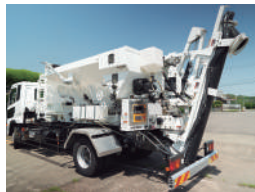
モルタルミキサー車 四国生コンクリート工業(株)
