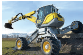
4輪多関節作業機械 スパイダー (株)サナース
