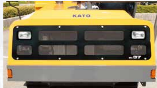
▲並列冷却ユニット
