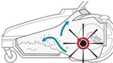
メインブラシが路面のゴミを効率良くダストコンテナに巻き上げます。
