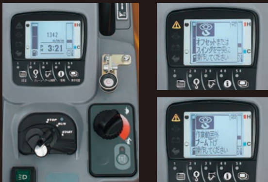
クレーン仕様機メーター周り
