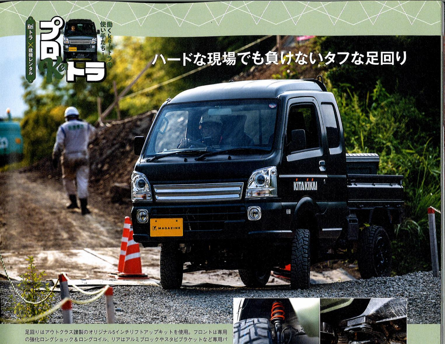
足回りはアウトクラス謹製のオリジナル5インチリフトアップキットを使用。フロントは専用の強化ロングショック＆ロングコイル、リアはアルミブロックやスタビライジングアームなど専用パーツを多数使ってリフトアップし、ジムニーばかりの走破性を実現！同社が扱うスズキコンプリート車にも使用するキットなので信頼性はバツグンだ
