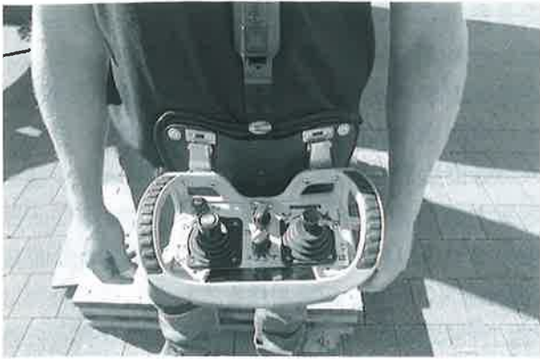
写真2 ジョイスティック式の無線操作盤
